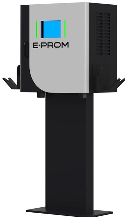
Зарядная станция для электромобилей E-PROM 30 с фирменным уникальным дизайном предназначена для заряда электротранспорта постоянным током мощностью до 30 кВт с применением двух видов разъемов в стандартном исполнении: CCS Combo 2 и GB/T.
